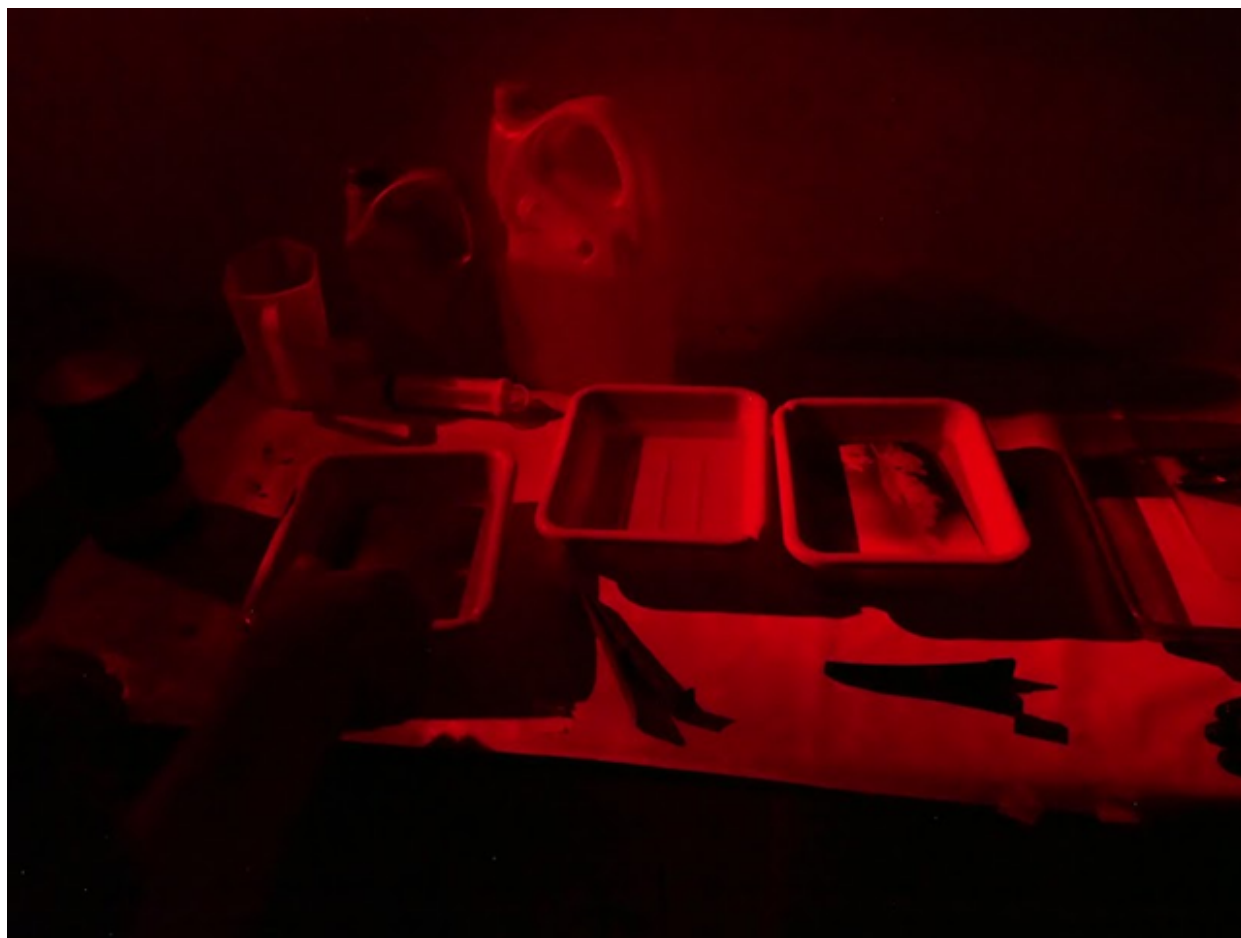
Obróbka w ciemni, od lewej kuwety: z wywoływaczem, przerywaczem, utrwalaczem (fot. Krzysztof Borowski, FotoSpółdzielnia)
